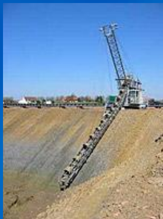
Extração mecânica da argila
